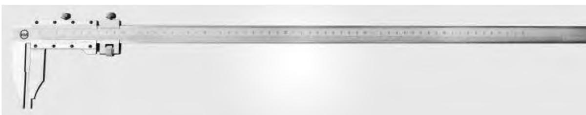
Рисунок 3 - Общий вид штангенциркулей типа ШЦ-III
