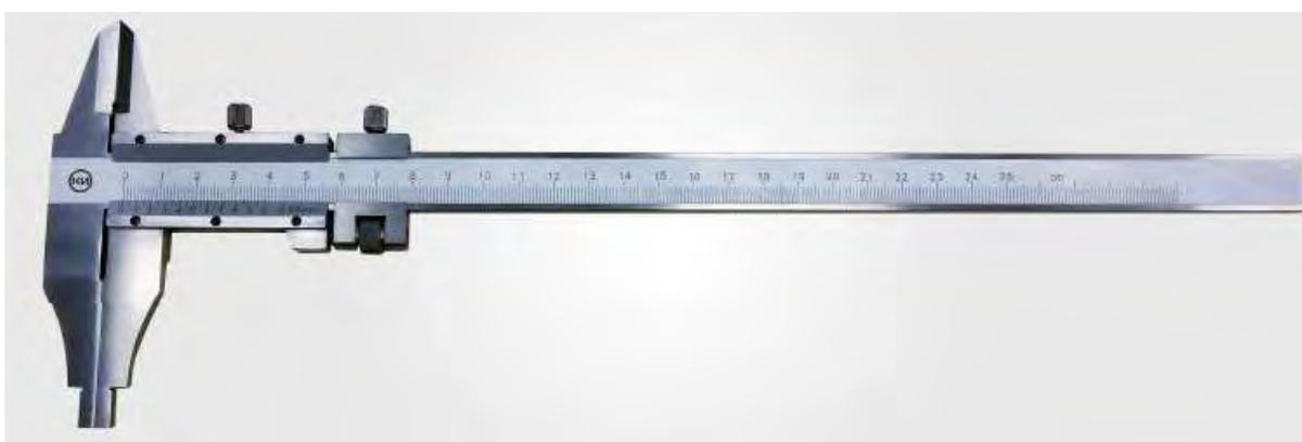
Рисунок 2 - Общий вид штангенциркулей типа ШЦ-II
