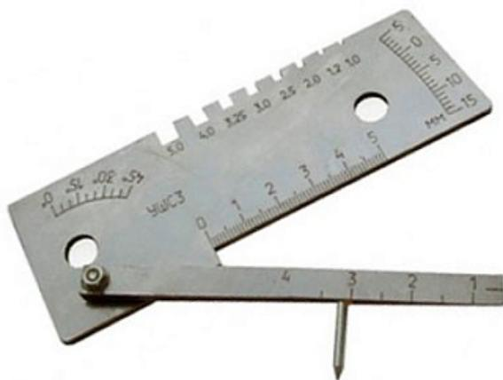
Шаблон сварщика универсальный УШС-3 используется для контроля качества сварных швов и позволяет определять параметры дефектов, таких как забоины, зазоры, притупления, углы скоса и превышения кромок.
