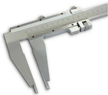
Тип ШЦ-III — с односторонним расположением губок для измерения наружных и внутренних размеров. В основном используются для измерения больших размеров (от 400 до 3000 мм). Для облегчения настройки на размер оснащён рамкой микрометрической подачи. Штангенциркуль имеет хромовое покрытие для обеспечения долговечности. Возможна поставка с поверкой.
