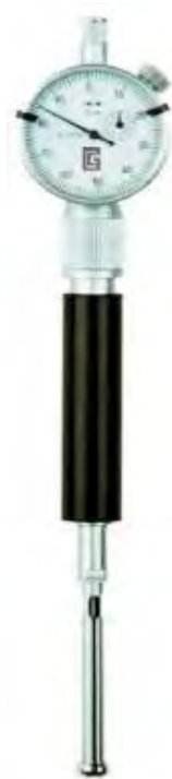
Рисунок 1 - Общий вид нутромеров индикаторных типа НИ с измерительным устройством цангового типа.
