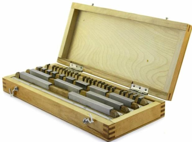
Меры длины концевые плоскопараллельные стальные являются наиболее точным измерительным прибором. Служат для проверки и градуировки мер и контроля размеров измерительных приборов, а также для наладки станков и особо точных разметочных работ. Для изготовления концевых мер длины используется высококачественная и износостойкая сталь и керамика. Наборы концевых мер длины обеспечивают возможность получения блока концевых мер любого размера до третьего десятичного знака.
