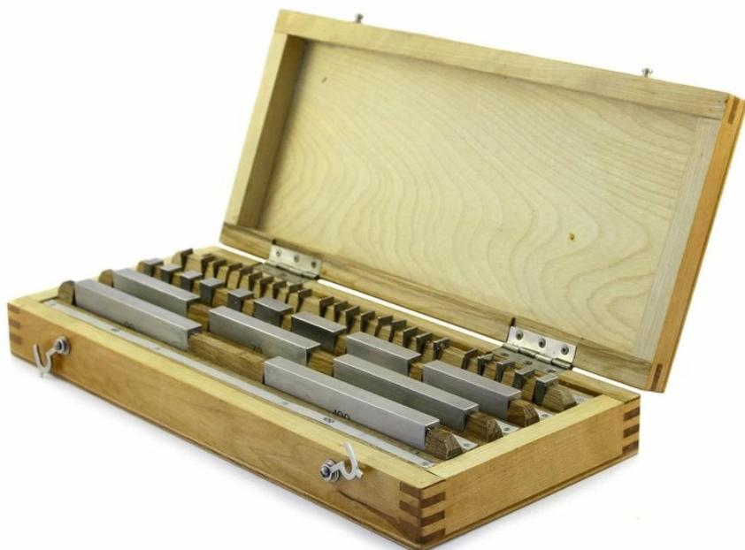
Плоскопараллельные концевые меры длины выпускаются наборами в соответствии с ГОСТом №9038 и используются при необходимости отстройки или регулирования приборов для измерений, а также при непосредственном измерении контролируемых размеров. Кроме этого, набор плоскопараллельных концевых мер применяется как единый эталон размера основных единиц длины.
